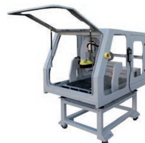
Fraiseuse équipée de la base en acier et de l'enceinte de sécurité
